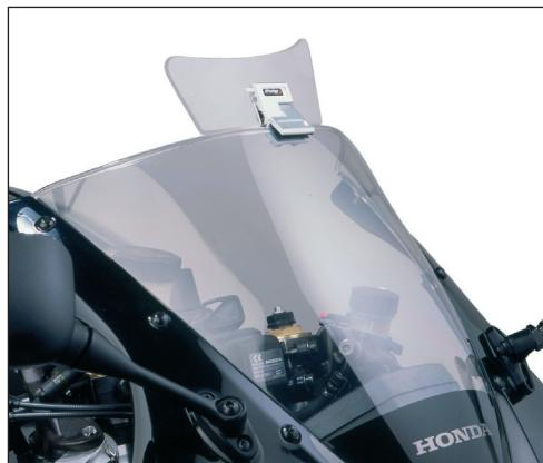
En las revisiones del vehículo es conveniente efectuar también el mantenimiento de apriete de toda la tornillería del deflecto, especialmente los tornillos que fijan éste a la cúpula.
